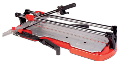
RUBI CORTADOR MANUAL CERAMICA PROFESIONAL TX Espesor de corte: 21 mm. Para el corte de Gres Porcelánico y Gres Extrusionado. Separador de 1.200Kg. de potencia. Sistema de medición angular para realizar cortes de 0 a 45°. Tope lateral para realizar cortes repetitivos rectos y a 15, 30 y 45°. Rodeles intercambiables de Ø 8 a 22 mm.
